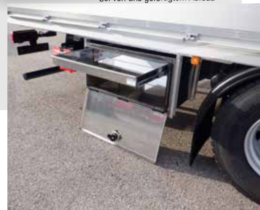
Leicht zugängliche Werkzeugboxen für zusätzlichen Stauraum. In Kunststoff, Alu, oder Niro. Lackiert oder unlackiert.
