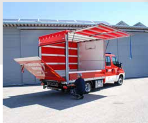
Seitenklappe wahlweise in Planen- oder Plattenbauweise
