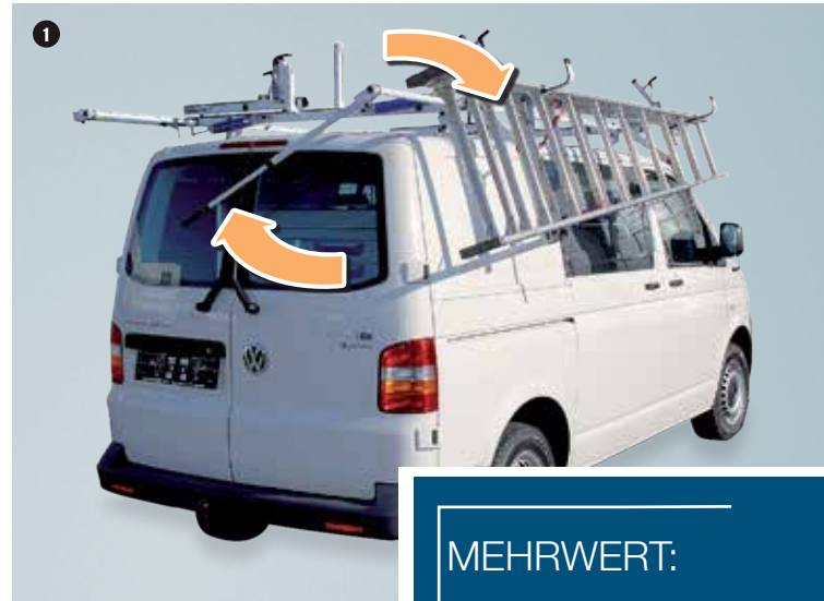
Leiternabsenkung (schnelle und bequeme Montage von Leitern am Fahrzeugdach)
