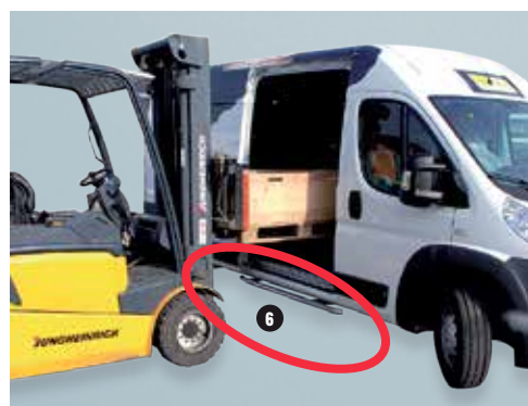
Stoßleiste zum Schutz der Holme bei seitlicher Beladung mit Staplern
