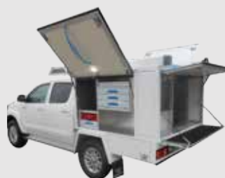
Eigenbau Plateau, daher große Seitenöffnung möglich.
